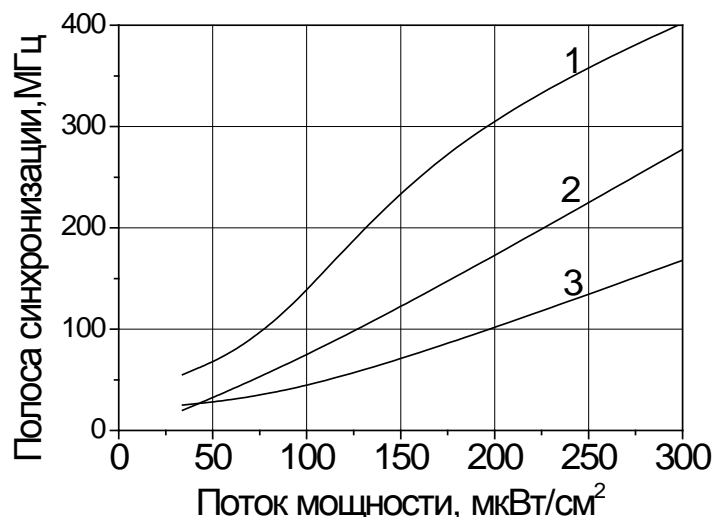
Рисунок 4. Зависимость полосы внешней синхронизации для отдельно взятой АГ (1) и линейных решеток из двух (2) и трех (3) взаимно синхронизированных АГ от потока мощности синхросигнала.
