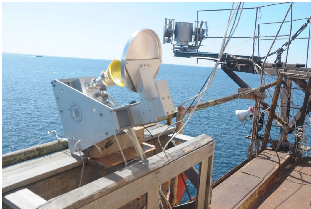
Рисунок 3.10 — Радиометр Р22М, установленный на океанографической платформе МГИ РАН
