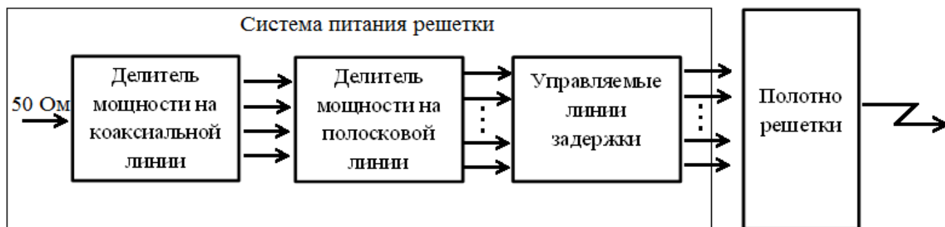
Рис. 4. Функциональная схема антенной решетки с системой питания
