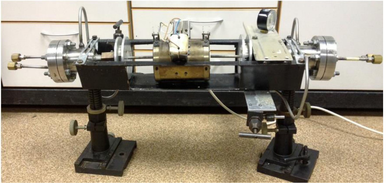
Рис. 2.4. Фотография газонасыщающей камеры, использовавшейся в большей части экспериментов.
